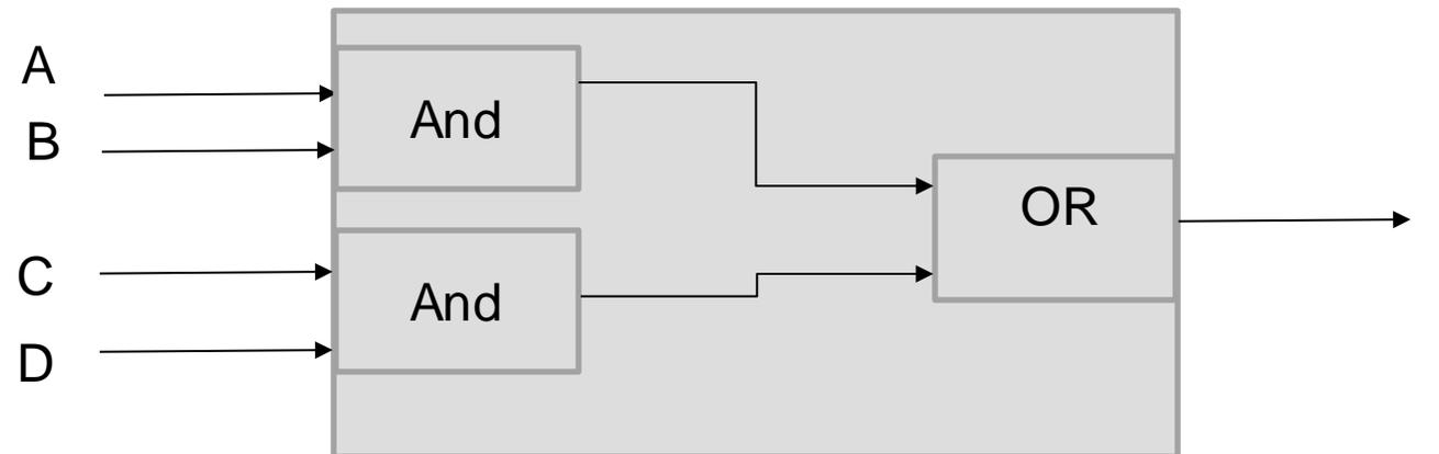
Esse tipo de arquitetura descreve os **componentes** do sistema digital e **suas interconexões**. Nessa arquitetura, a atribuição de sinais é realizada a partir do **mapeamento de entradas e saídas** de cada componente
