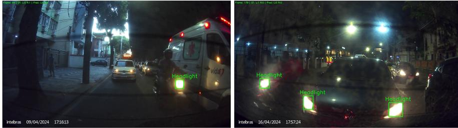
**Figura 5. Amostras noturnas em que nenhum VRU foi detectado pelo YOLO, mas o mecanismo de apoio por detecção de farol inferiu com sucesso a presença de possíveis veículos.**
