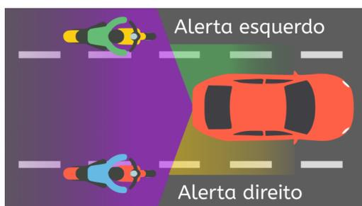
Figura 3. Definição dos alertas laterais (esquerdo e direito) no conjunto de dados FilterLane-VRU.
