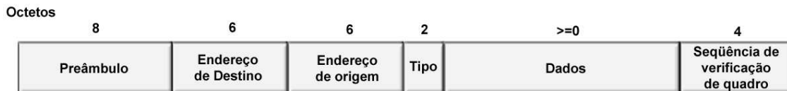
Figura 5.2: Formato do quadro MAC da Ethernet.
