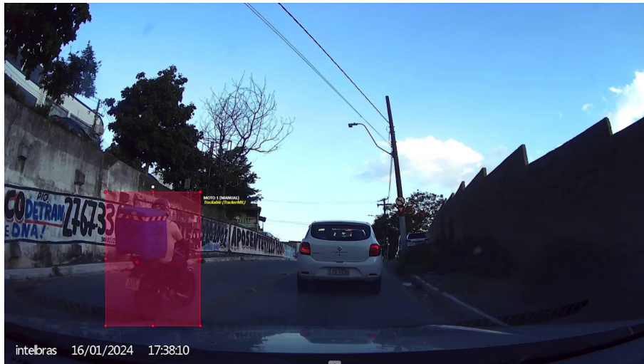
Figura 4.1: Exemplo do protótipo inicial descartado: bounding boxes para detecção de VRUs. Fonte: Canal do Youtube Grupo de Teleinformática e Automação - GTA [2]
