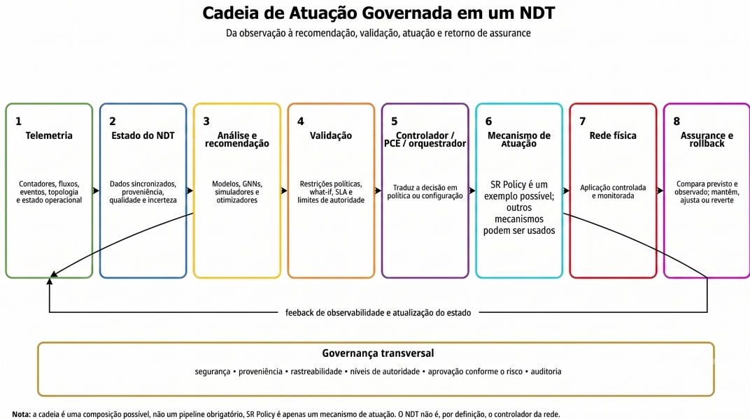
Figura 4.11. Cadeia de atuação governada em um NDT. A cadeia representa uma composição possível entre telemetria, estado do NDT, análise, validação, controle, atuação, garantia e reversão ao estado anterior. As etapas e o grau de automação variam conforme o domínio e o risco operacional.
