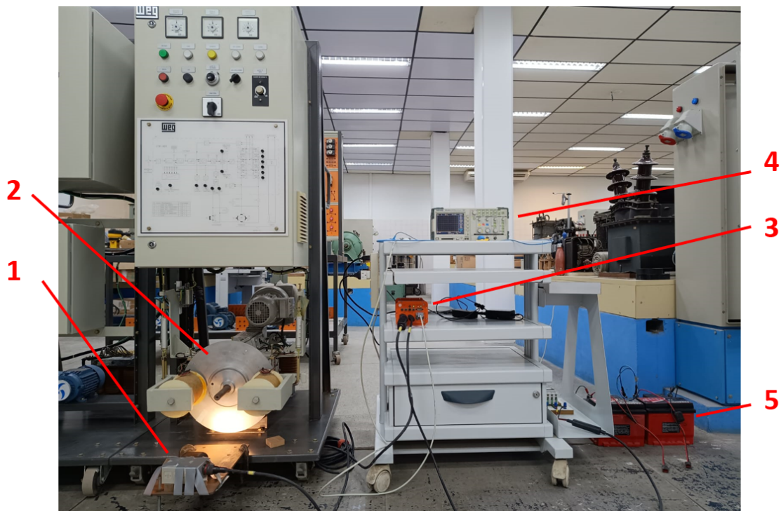
Figura 4.5: Equipamentos utilizados na calibração do sensor de velocidade.
