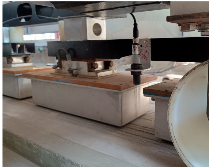
Figura 2.10: Posicionamento do sensor ultrassônico no chassi (fonte: [3]).
