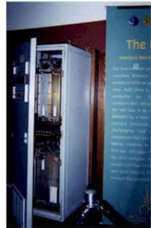
Minicomputador Honeywell DDP516 24kB de memória 10 kHz de relógio
