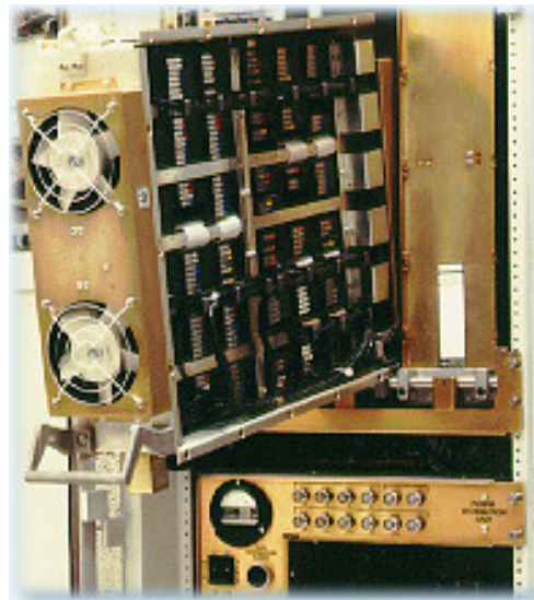
Minicomputador Honeywell DDP516 24kB de memória 10 kHz de relógio
