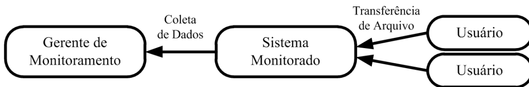
Figura IV.1: Cenário de testes para análise dos falsos positivos e falsos negativos do sistema ADAGA.
